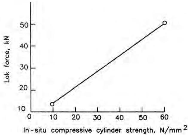
**Fig. 3.4.2. Calibration Chart for LOK Test<sup>1</sup>**
