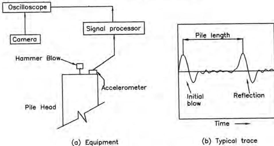
Fig. 3.10.3. Pulse Echo Method<sup>11</sup>
