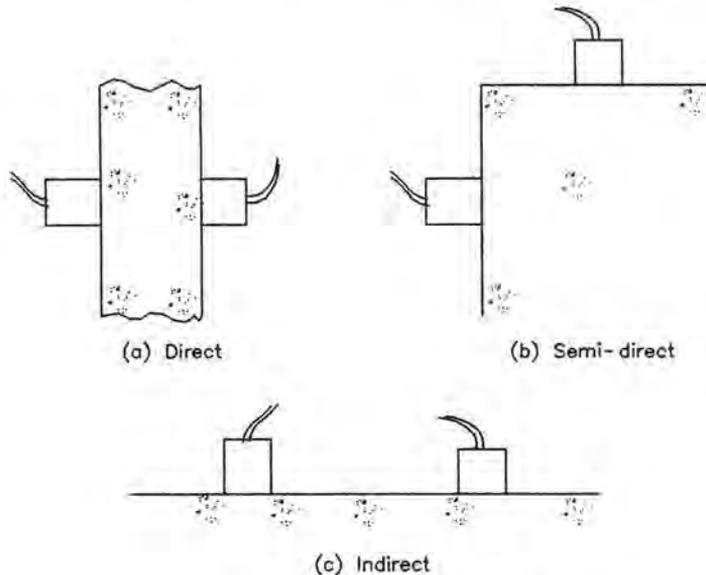
**Fig. 3.8.1. Types of Reading<sup>8</sup>**
