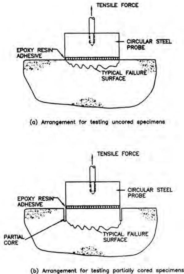
Fig. 3.7.1. Pull-off Test<sup>67</sup>
