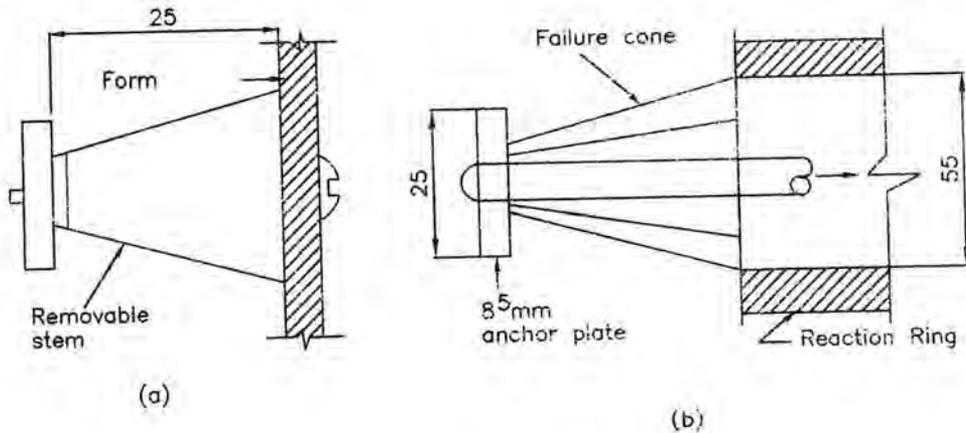
Fig. 3.4.1. LOK Test Assembly<sup>1</sup>
